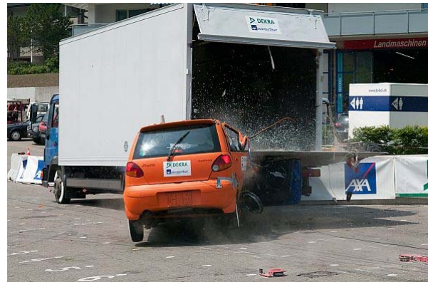
► Bild: DEKRA Crashversuch PKW gegen Hubladebühne
